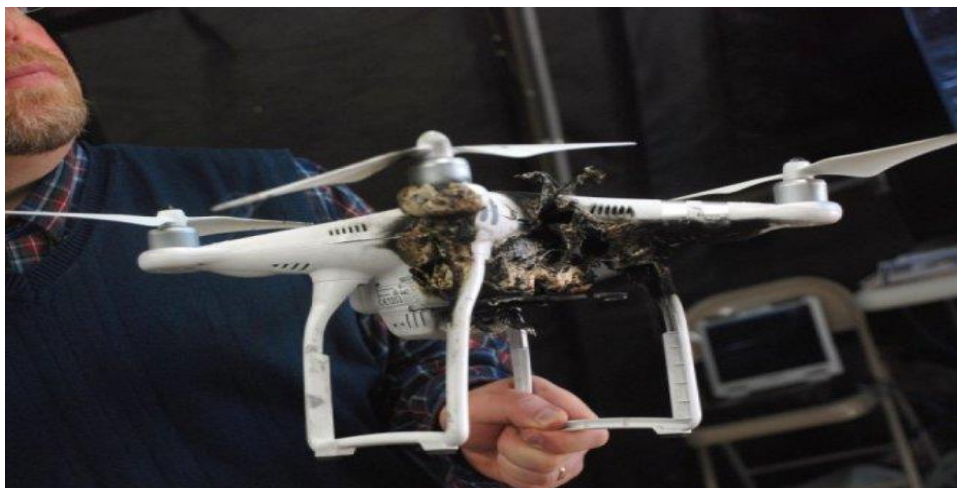
Рисунок 7 – Результат воздействия лазерной системы на БПЛА
