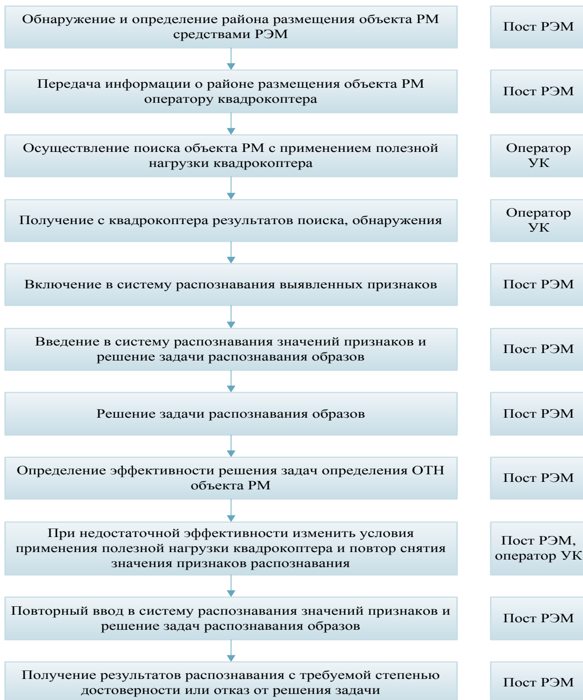
Рисунок 2 – Способ взаимодействия поста РЭМ с оператором управления квадрокоптером при решении задач распознавания объекта мониторинга
