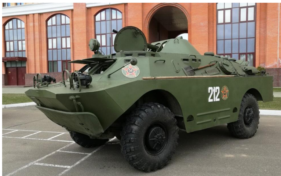
Рисунок 2 – Бронированная разведывательно-дозорная машина БРДМ-2
