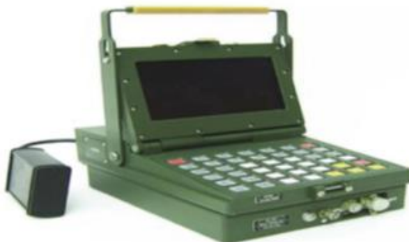
Рисунок 1 – Полевой компьютерный диагностический комплекс бронетанковой техники (ПКДК-БТ)
